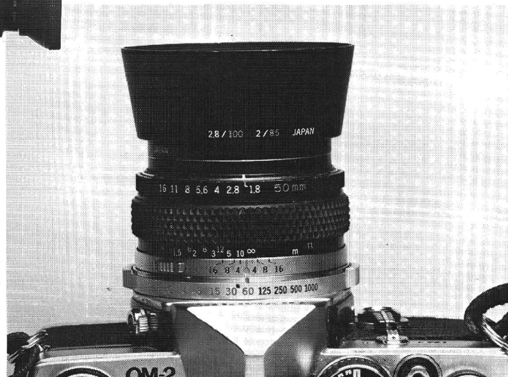
Modlysblænderen til 85/100 mm optikken er mere effektiv end »standarden« til 50 mm'eren.
